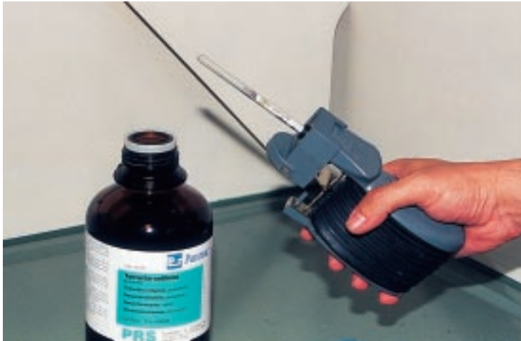
Medición con tubo detector genérico cualitativo (Politest, Qualitest, ...)
