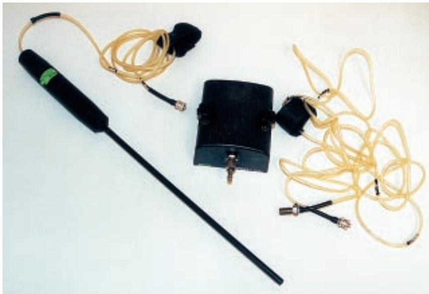
Sonda y líneas de muestreo acoplables a la bomba de aspiración
