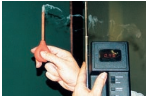
Medición con velómetro y tubo fumígeno
