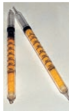
Medición con tubo detector específico cuantitativo para amoníaco
