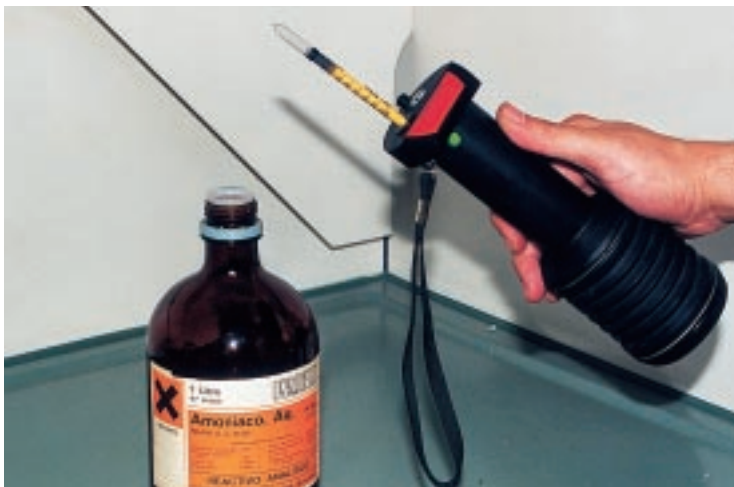
Medición con tubo detector específico cuantitativo para amoníaco
